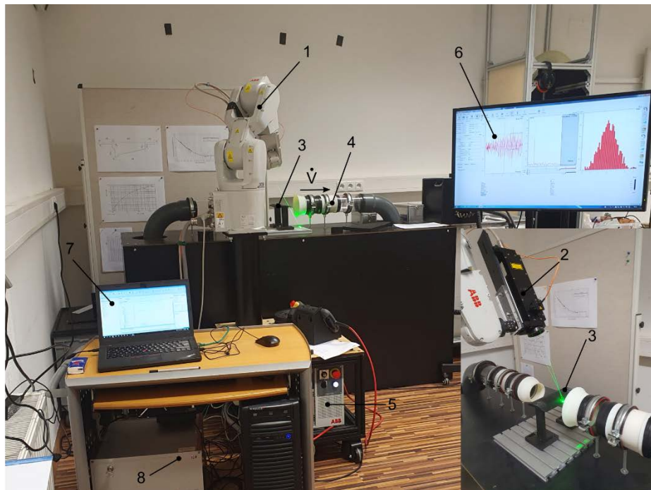
Abb. 2: Experimenteller Versuchsaufbau: 1 ... Roboter ABB IRB 1200 7kg 0.7m, 2 .... LDA ILA fp50-shifted, 3 ... NACA 6412 0° AoA, 4 ... offener Windkanal, 5 ... Robotersteuerungseinheit, 6 ... LDA Mess-Bildschirm, 7 ... Laptop mit RobotStudio® 2021 zur Robotersteuerung, 8 ... LDA Messauswerteeinheit (Hardwarefilter) und Versorgung für den Laser.
