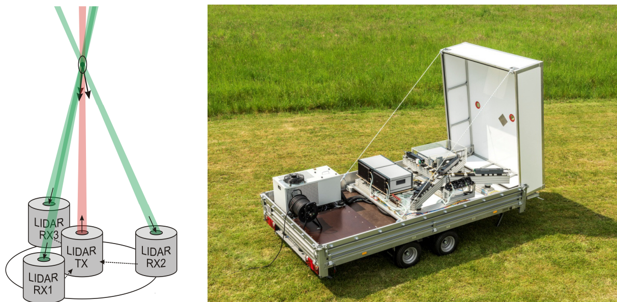
Abb.1: Prinzip und Aufbau des bistatischen Wind-Lidar-Systems der PTB
