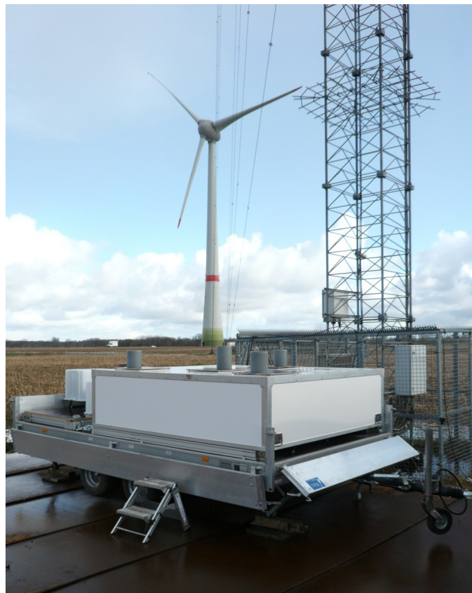
Abb. 2: Einsatz des PTB-Lidars am Windmessmasten
