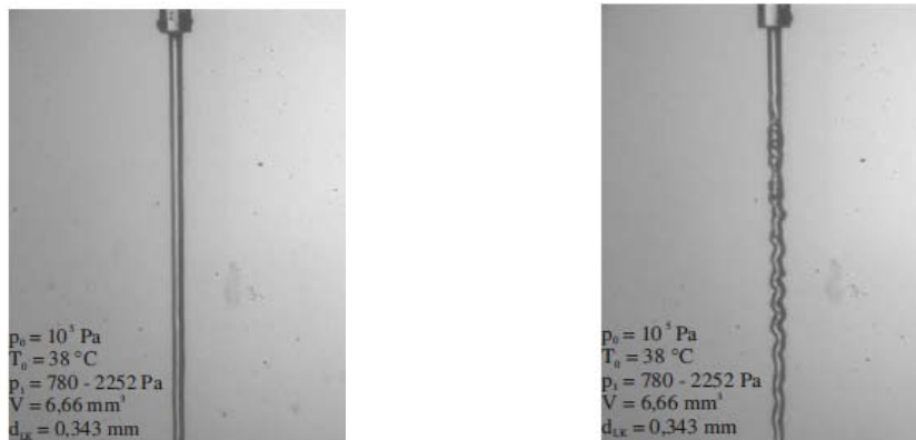
Abb.2: Glatter laminarer Strahl (links) und gestörter Strahl (rechts) bei T_0=38^\circ\text{C} . atm. Druck p_0 . Kammerdruck p_i während des Einspritzens. Volumen der Kapillare V . Durchmesser der Kapillare d_{LK}=d .
