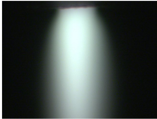
Abbildung 3: Plasmastrahl mit innerem und äußerem Bereich
