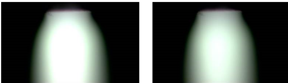
Abbildung 4: Intensitätsschwankungen im Plasmastrahl
