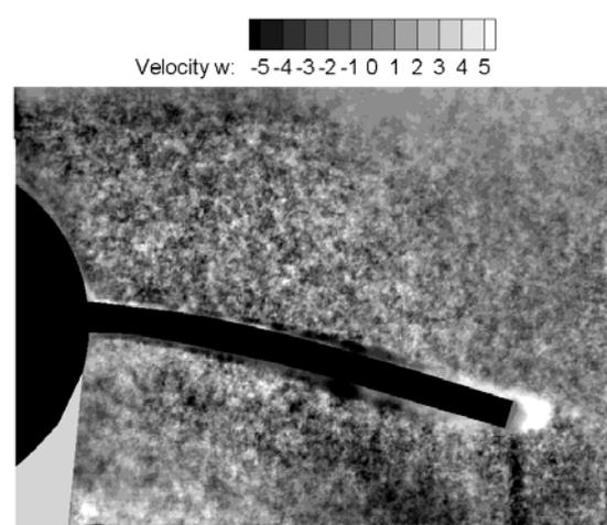
Abb. 7: Geschwindigkeit in z-Richtung in [m/s]
