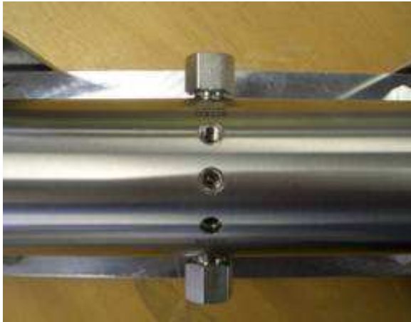
Abb. 5 (links): Sicht von oben auf den angefertigten Aufbau. Außer den Sichtfenstern befinden sich auf Versuchszelle auch die Anschlüsse für die notwendigen Sensoren bzw. Einlass für Gas/Probe (weitere Bohrungen).
