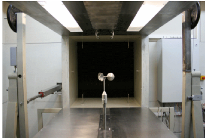
Bild 1: Schalensternanemometer in einem WindGuard-Kalibrierwindkanal Göttinger Bauart
