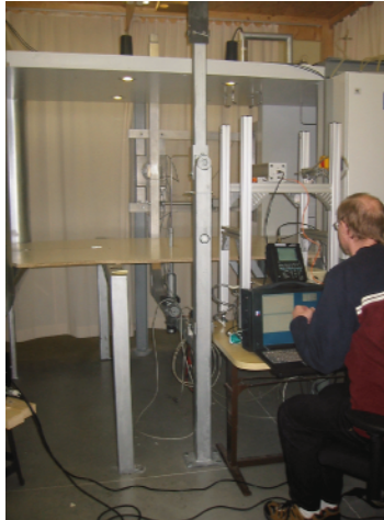
Bild 4: Aufbau der LDA-Messanordnung am Kalibrierwindkanal der Deutsche WindGuard GmbH in Varel
