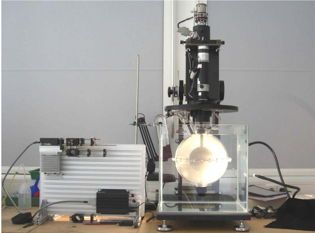
Abb. 6: Aufbau des Laborexperiments für den Nachweis von Wellenattraktoren in der sphärischen Geometrie.
