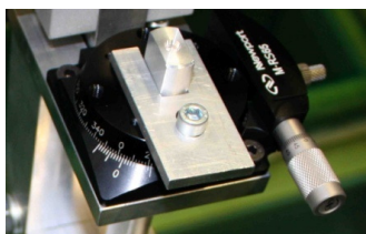
Abb. 3: Rotationstisch zur Verstellung des Anstellwinkels
