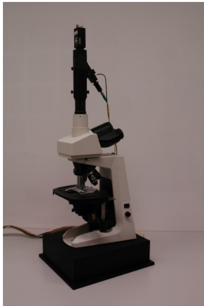
Abb. 2: Fotografie des modularen Filtersystems
