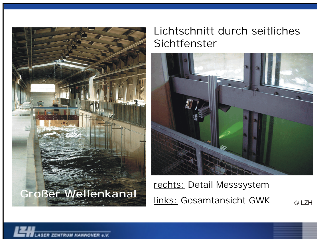
Abb. 5: 3D-PIV Messungen am Großen Wellenkanal (GWK)
