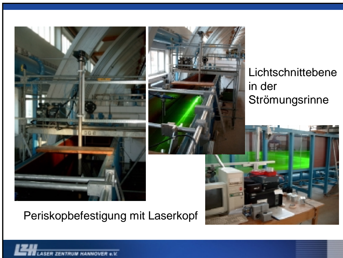
Abb. 8: Periskopaufbau an der Strömungsrinne Schneiderberg
