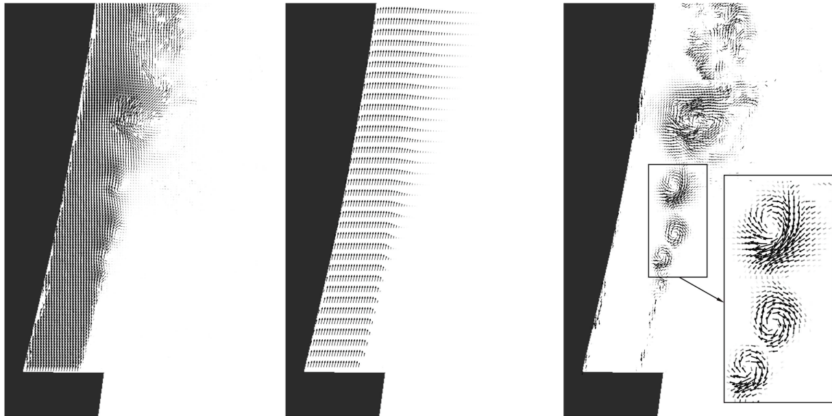
Abb. 3: Momentanes Geschwindigkeitsfeld (links), gemitteltes Geschwindigkeitsfeld (Mitte) und Vektorfeld der zeitlichen Fluktuationen (rechts) im Bereich des Düsenaustritts. Mittlere Düsenaustrittsgeschwindigkeit 42m/s. Unbeheiztes Konturmodell.
