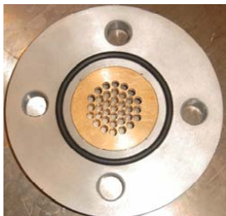
Abb. 6: Ansicht des verwendeten Mitsubishi-Gleichrichters
