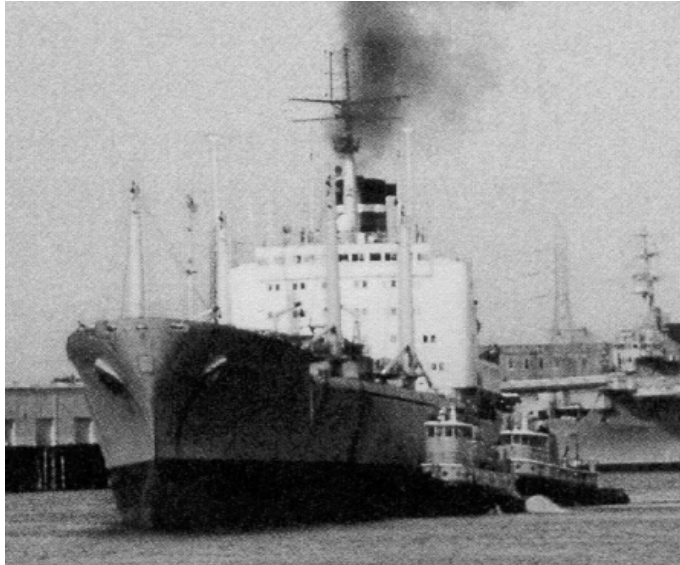
Bild 1 Stark rußendes Schiff bei Teillastbetrieb (5)
