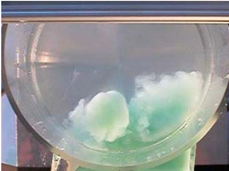
Bild 8: Blick in den Zylinder, Draufsicht vom Spülvorgang. Der auslassnahe Überströmkanal ist teilweise versperrt, optimierte Kanalgeometrie.
