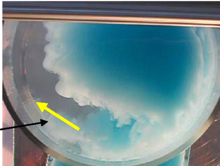
Bild 7: Blick in den Zylinder, Draufsicht vom Spülvorgang. Der auslassnahe Überströmkanal ist teilweise versperrt.
