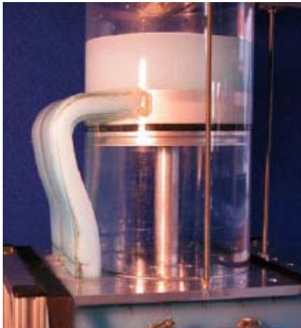
Bild 2: Detailansicht vom Versuchsaufbau, Zylinder mit Überströmkanal
