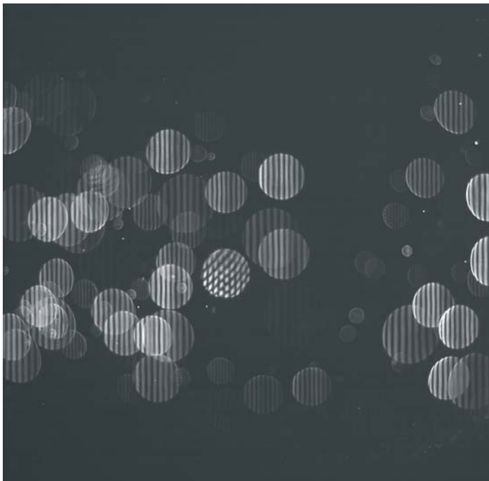
Abb. 3: Aperturbilder von Feststoffpartikeln mit einem Durchmesser von ca. 12 \mu\text{m} mit dem Doppel Planar Objektiv unter \phi=90^\circ aufgenommen.
