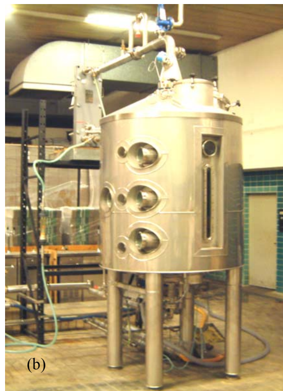
Abbildung 2: (a) Messanordnung (1 Zargenschauglas, 2 Schauglas Klörperboden, 3 überspiegeliges Einströmen, 4 unterspiegeliges Einströmen (Subjet)), (b) Dampfbeheizte Würzepfanne mit Innenkocher im Technikumsmaßstab
