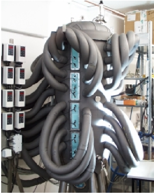
Abb. 3: Gär- und Lagertank mit den optischen Zugängen
