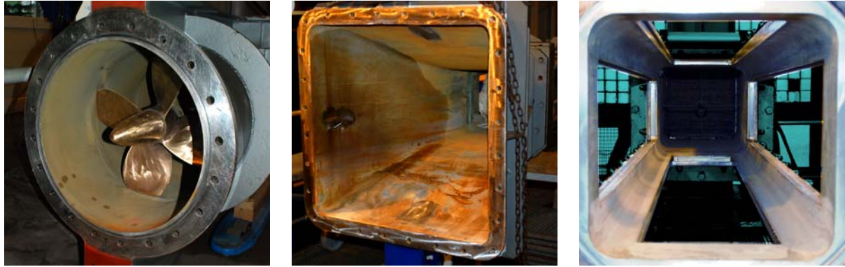
Abbildung 1: Details des geöffneten Tunnels: Impeller, Düse und ein Blick in die Messkammer
