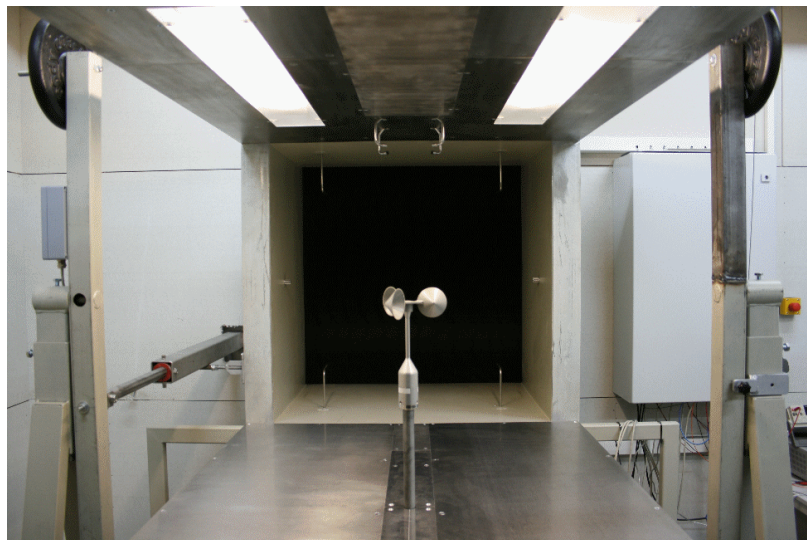
Abb. 1: Blick auf die 1 m x 1 m Windkanalaustrittsdüse, im Vordergrund ein zu kalibrierendes Schalensternanemometer in der Prüflingsposition, im Hintergrund an den vier Windkanallecken jeweils ein Prandtl-Rohr und oben die Sensoren eines Ultraschallanemometers
