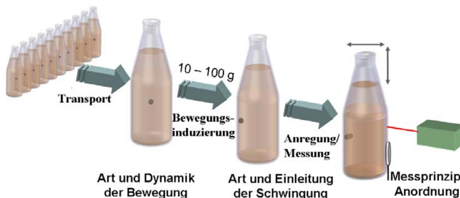
Abb. 1: Schematischer Ablauf der Fremdkörpererkennung und zu lösende Fragestellung
