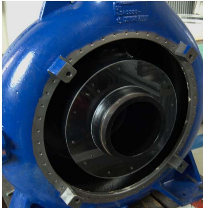
Abb. 5: Für PIV Messungen vorbereitetes Laufrad
