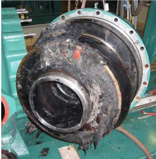
Abb. 1: Feststoffansammlungen im Radseitenraum von Abwasserpumpen
