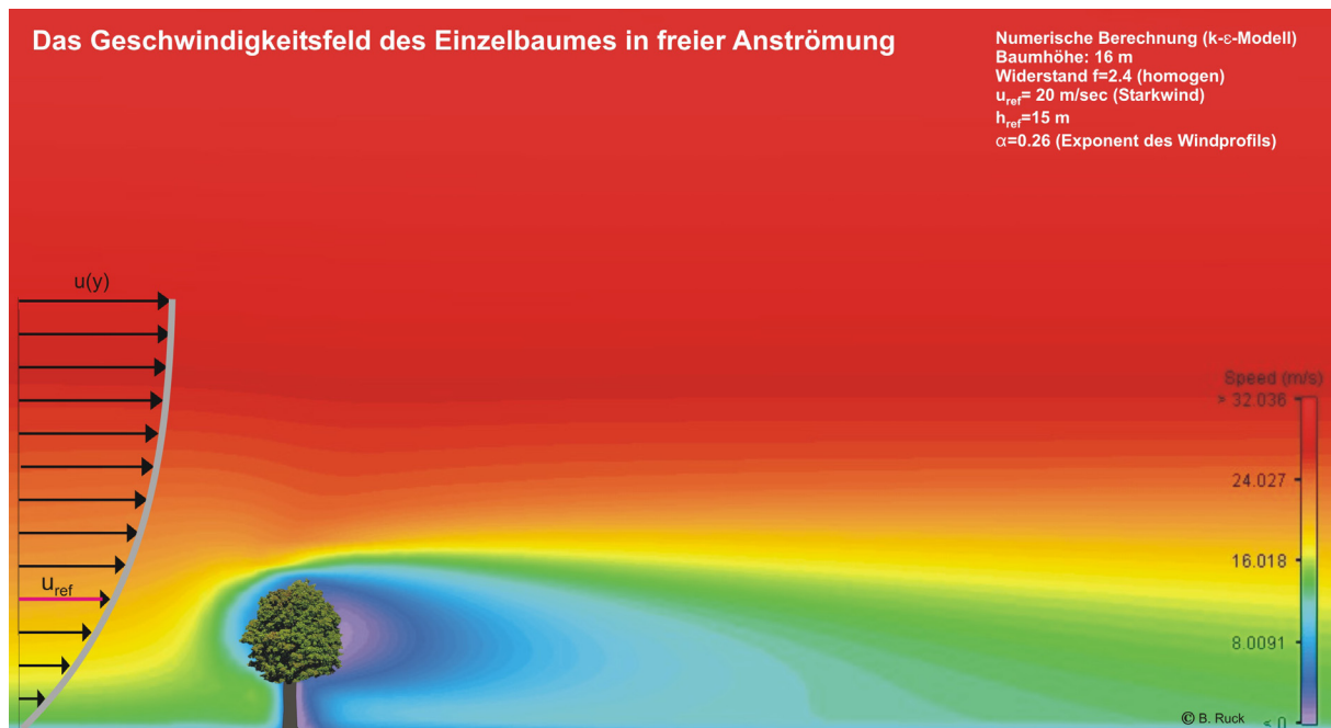
Abb. 7: Verlauf der (mittleren) horizontalen Windgeschwindigkeit bei der Einzelbaumumströmung
