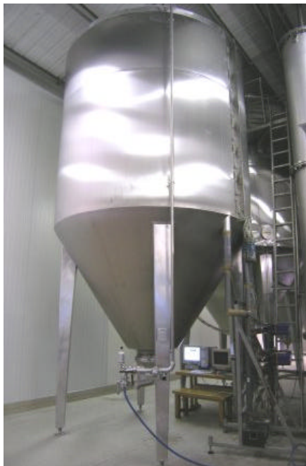
Abb. 4: 30.000 Liter Brauereitank mit seitlichen Messöffnungen
