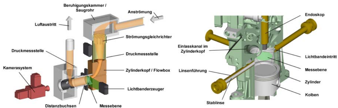
Abbildung 3 : Versuchsaufbauten zur DGV-Messung [3]
