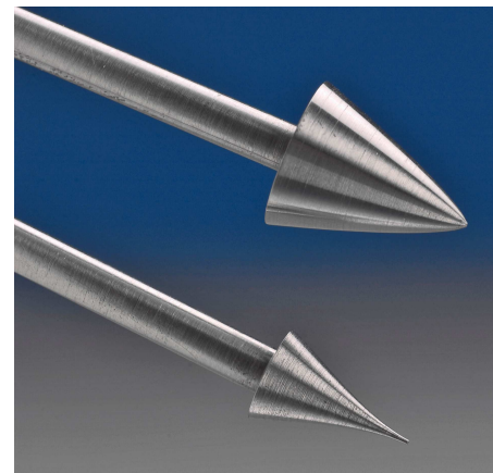
Abb. 5: Vorkörper mit konvexer und konkaver Kontur
