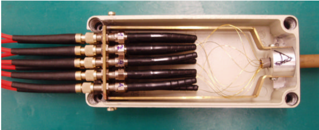
Bild 4. Ansicht der geöffneten Koppereinheit (rechts Keramikschutzrohr, links Koppellichtleitkabel)
